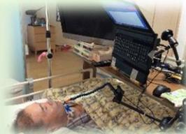
午後のひととき、PCで音楽を聴いたり友人や家族にメールを打ったりして過ごしている。手や足は動かないので、ポイントタッチスイッチというスイッチひとつでPC操作やテレビのリモコン代わり、ナースコールの呼出しに使えるスイッチを使っている。口を開けたときに顎でスイッチを押せるようにセットしているため、あくびをしたときにもスイッチを押してしまうことがあるが、それ以外は概ね快適に使えている。
